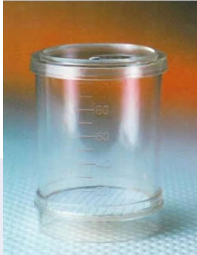
La base está diseñada con rayos en relieve para facilitar y aumentar el flujo de líquido filtrado, a la vez soporta el pad absorbente que protege la membrana filtrante cuadriculada de nitrocelulosa. Consta además de un orificio central inferior que permite el escape de aire y líquido filtrado.
